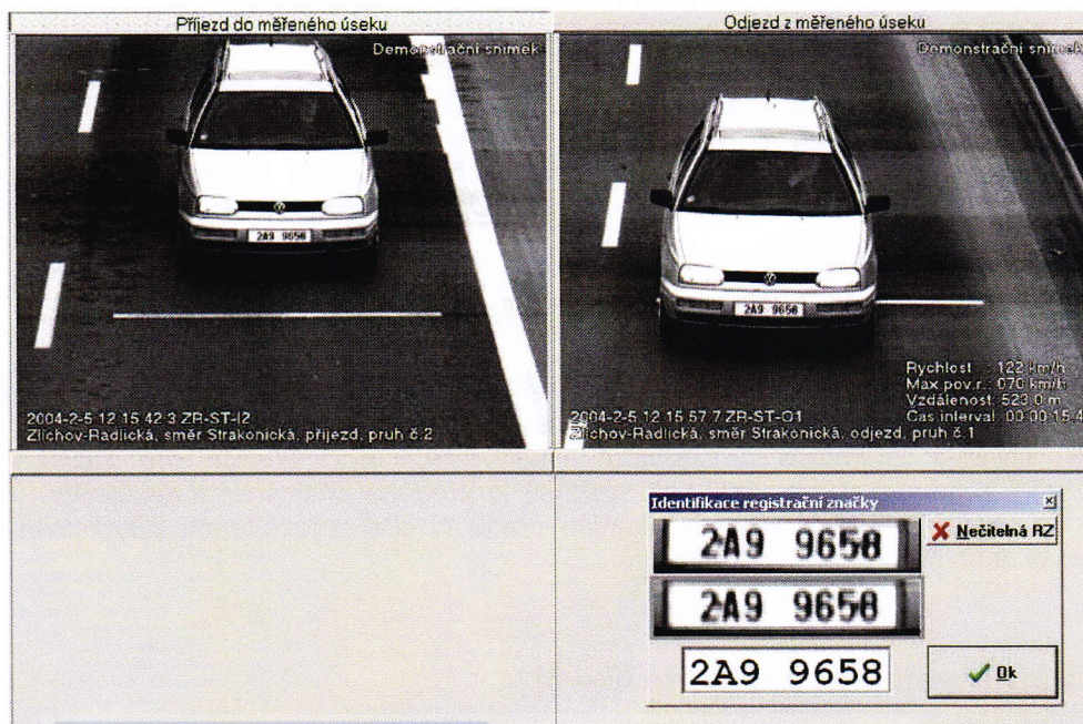
Obrázek č. 20 - Příklad záznamu přestupce systémem pro měření úsekové rychlosti
